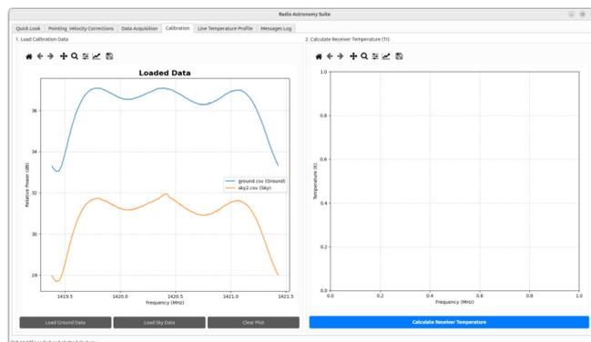
1. 먼저, 해당 버튼을 클릭하고 적절한 파일을 선택하여 **지상(ground)** 및 **하늘(sky)** 데이터를 로드해야 한다. 데이터가 로드되면 왼쪽 그래프에 하늘과 지상의 상대 출력(power output)이 표시된다.
