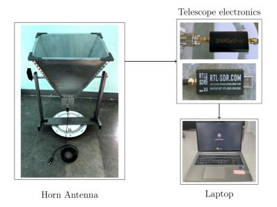
• Um radiotelescópio de antena corneta em uma montagem altazimutal. O azimute pode ser medido com a escala de transferidor na base da montagem. A altura pode ser medida usando o inclinômetro digital, conforme mostrado abaixo.
